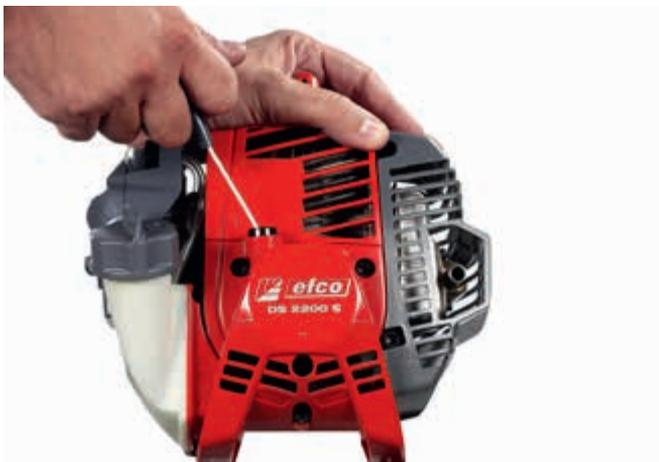
«**EasyOn-Start**»: Leichtes und kräfteschonendes Starten durch eine zusätzliche Feder zwischen Kurbelwelle und Anwerfseilrolle. Ein ruhiger, gleichmässiger Zug genügt.
