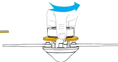
Im Uhrzeigersinn drehen, am Anschlag nach oben ziehen und wieder im Uhrzeigersinn drehen. Der Ring verriegelt sich in der offenen Position, um die Montage der Flügel zu gestatten.
